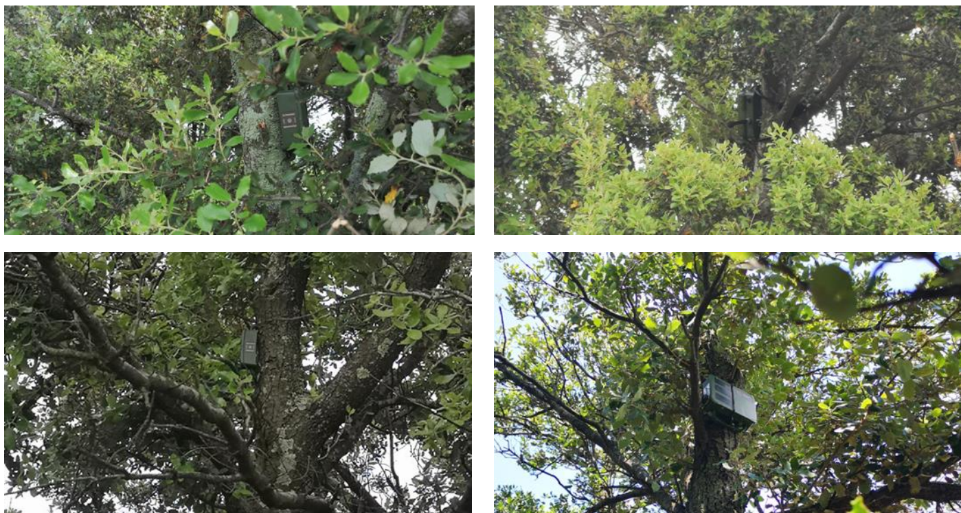
☞ Photographies 26 , 27 , 28 , 29 : Enregistreurs SMBat et SMMBat mis en place sur un site d'étude
